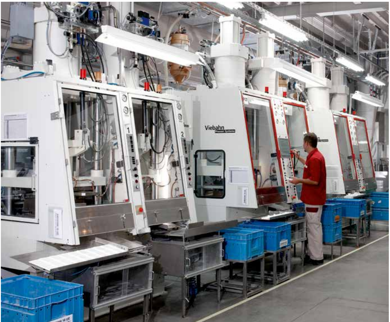
SchoPlast ist führend im Bereich der Duro- und Thermoplastverarbeitung im Spritzgießverfahren.
